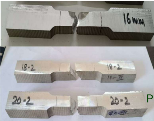
UTS Values of T8 & T-86 FSW Al Alloy AA 2219
